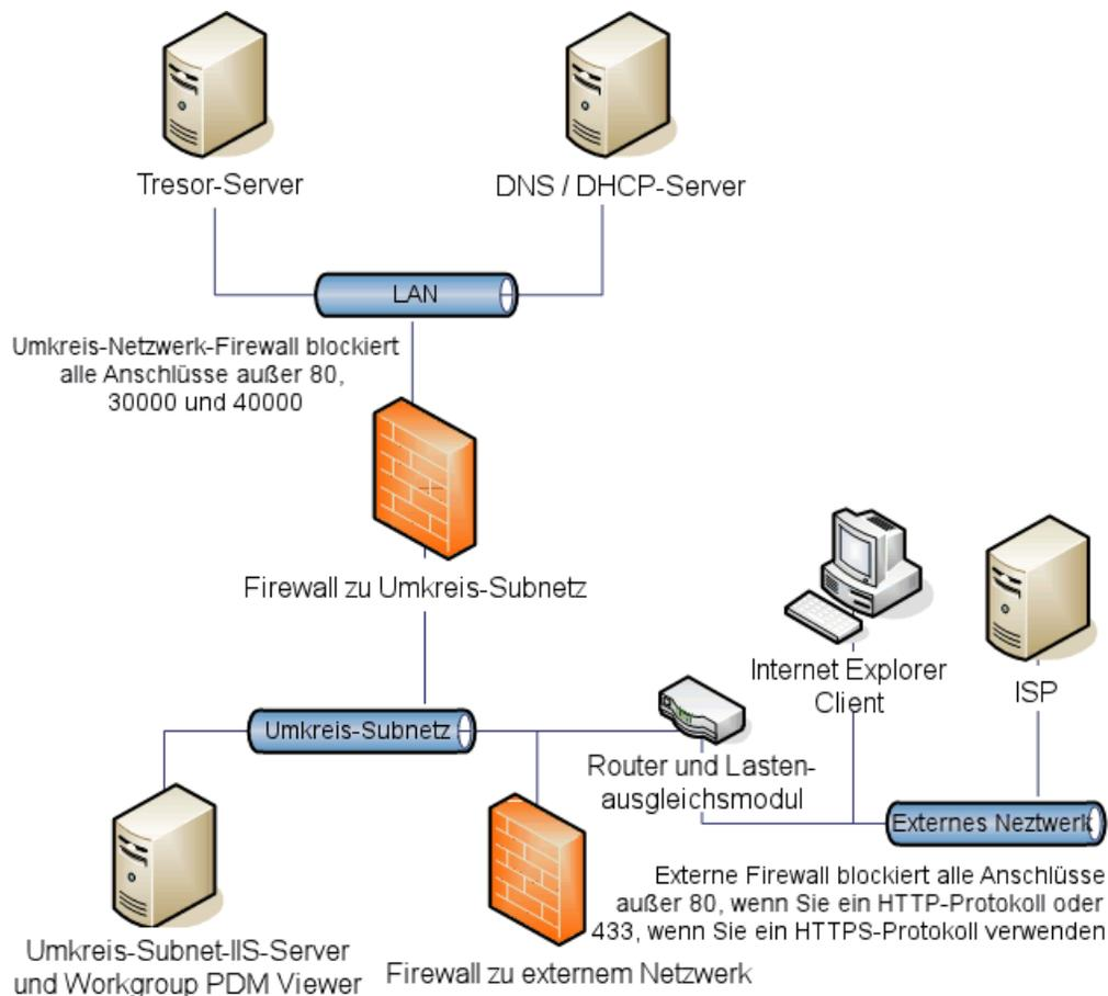
Der Internet Explorer Client stellt eine Verbindung zum Workgroup PDM Viewer/IIS-Server über den Anschluss 80 her (oder 443, wenn die Verwendung eines SSL konfiguriert ist). Der Workgroup PDM Viewer stellt dann über die Anschlüsse 30000 oder 40000 eine Verbindung zum Tresor-Server her. Der Tresor-Server sendet die angeforderte Informationen zurück zum Workgroup PDM Viewer, der dann die Informationen zurück an den Internet Explorer Client sendet.
