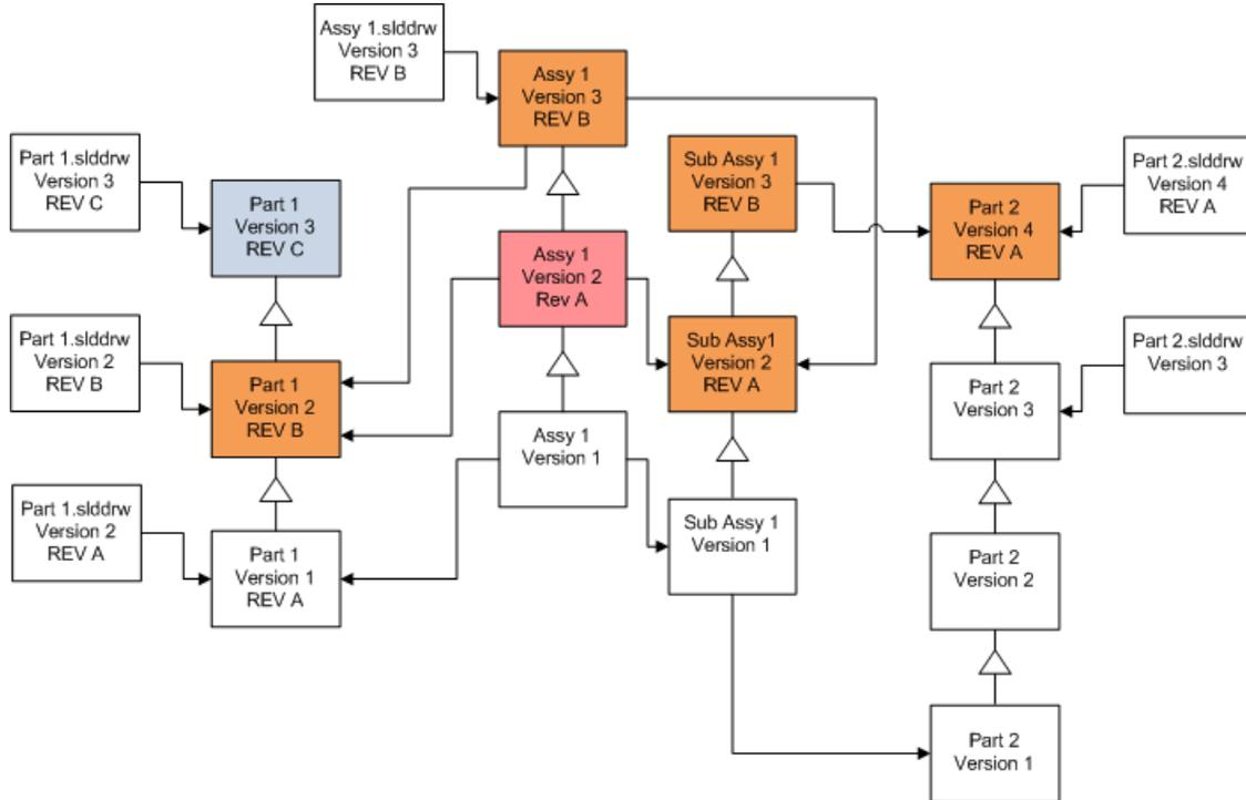
In einem referenzierten Versionsstrom aktualisiert das Werkzeug Dateiversion-Aktualisierung die letzten Teile, wie durch die blauen  Felder gekennzeichnet ist.
