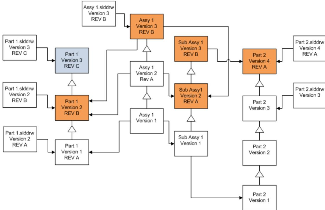
In einem referenzierten Versionsstrom aktualisiert das Werkzeug Dateiversion-Aktualisierung die letzten Teile, wie durch die blauen  Felder gekennzeichnet.
