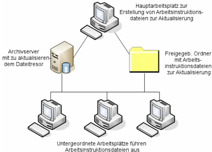
Die Arbeitsinstruktionsdateien enthalten Baumstrukturen, die die Eltern-Kind-Beziehungen der SOLIDWORKS Dateien widerspiegeln. An über- und untergeordneten Arbeitsplätzen können nach der ersten Arbeitsinstruktionsdatei weitere Arbeitsinstruktionsdateien ausgeführt werden. Obwohl Teile und Unterbaugruppen von anderen Baugruppen gemeinsam genutzt werden können, wird jede Datei nur einmal aktualisiert.
